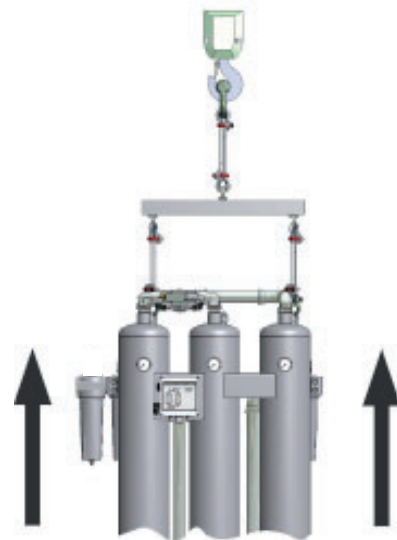
II: Opstellen met kraan
